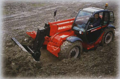
ERDARBEITEN: Heben/Absenken + Graben und ausschütten
