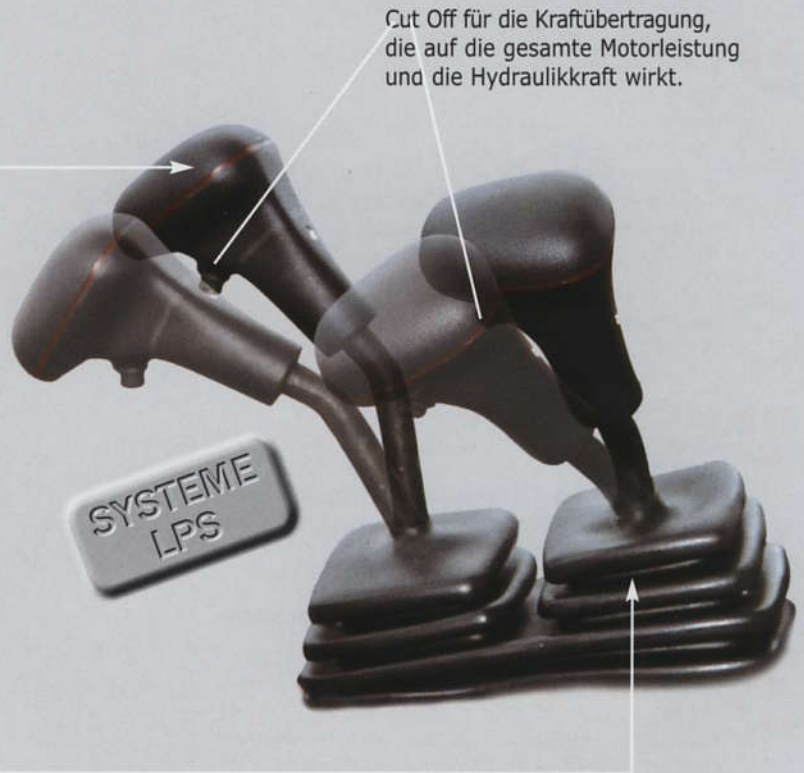
TRANSPORT: Heben/Absenken + Ausfahren/Einfahren des Teleskops
